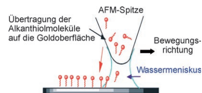
Abbildung 3. Strukturierung von Oberflächen mit Dip-Pen-Nanolithographie (DPN).
